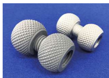
ボルト・ナット（左：造形品 右：焼結品）
