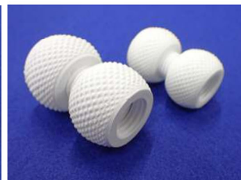
ボルト・ナット（左：造形品 右：焼結品）
