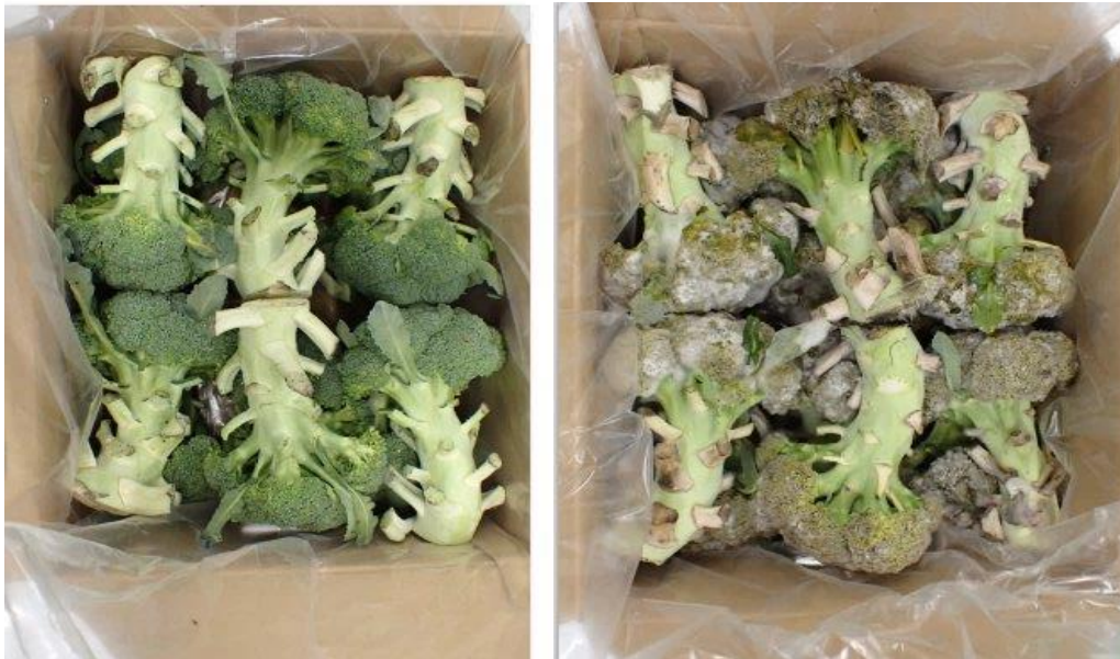
実証実験結果：（左）モイスト・クールシステム（右）一般冷蔵庫
